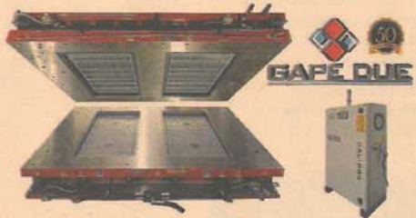
Stampo 2 uscite 60x120 cm isostatico per produzione di piastrelle monocolor completo di centralina idraulica
